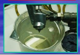
塗料 ノズルに洩れがないかシンナーか水に 塗料 ノズルの先端を付けて確認 しください。 気泡 (ブクブクという泡)がでたら塗料 ノズルが ゆるんでいるか ノズル・ニー ドルの摩耗です。 もう一度スパナできちんと締め込んでください。 止まらない場合は ノズル・ニー ドルセットで交換 してください。
