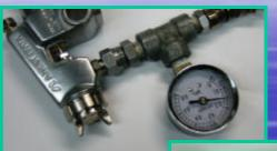
塗料ニップルにエアを接続し、エアーの圧力 0.15MPaに設定し。 空気キャップは外してぐざい。 注意 水を使用した場合は最後に必ずエアブローで水滴を飛ばしてください。
