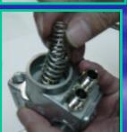
ニードル弁バネとピストン押しバネを手で押さえながらセットしてください。
